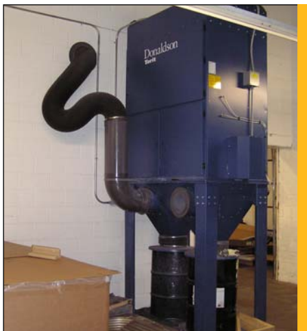
UMA 450 filtering plastic from a CNC machine
